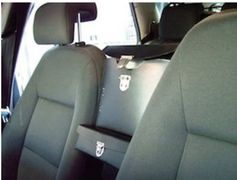
Bild 2. Polisiär utrustning skall ha en placering och lastsäkras så att skadorna minimeras hos personalen vid en eventuell olycka. Pustdatorer i specialväskor mellan framstolarna i en polisbil. Foto: Sören Wictorsson.
