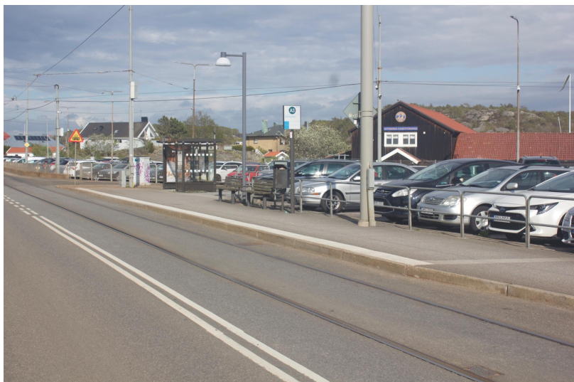
Bild 13-15. Vändslinga med tre hållplatser. Överst påstigning för gående med stort avstånd från vagnsgolv till perrong. I mitten avstigning för samtliga. Nederst öpphöjd perrong och påstigning för rullstolar. Foto: Per Olof Larsson
