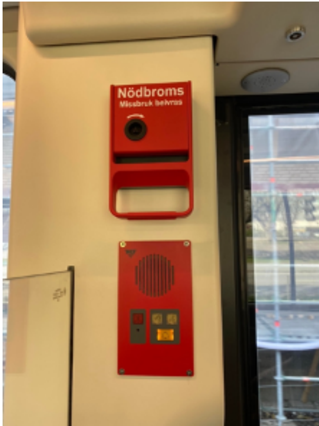
Bild 20. Spårvagn M33, nödbroms som inte går att nå för en rullstolsanvändare. Foto: Robert Kindberg
