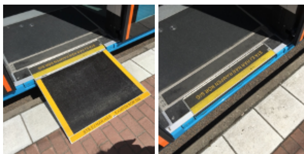
Bild 17. Spårvagn M33 med utfälld ramp och infälld ramp. På M33 finns en uppmaning till passagerare att inte trampa på rampen. Foto: Per Olof Larsson
